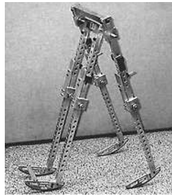
Abbildung 1.1: McGeers passiv dynamische Laufmaschine bewegt sich schwingend wie ein Pendel ohne Motorkraft und zusätzliche Kontrollen eine leicht schiefe Ebene herab ([12]).
