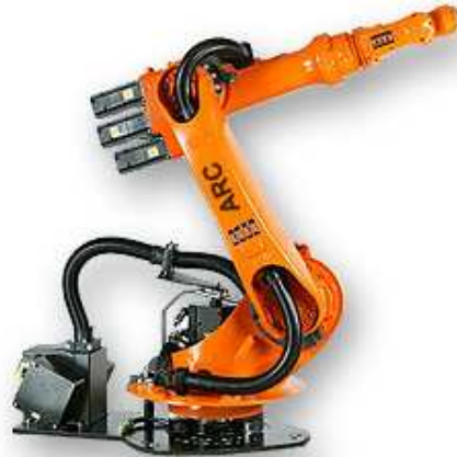
Abbildung 3.11: Industrieroboter, wie dieser (KR 6 ARC, KUKA Roboter GmbH), haben oft vorbestimmte, einseitige Arbeiten zu verrichten. Statt Flexibilität steht hier meist die Präzision im Vordergrund. Es müssen vorbestimmte Koordinaten oft zeit- oder energieminimal erreicht werden. Gesucht ist hierbei der optimale Steuerungsverlauf.
