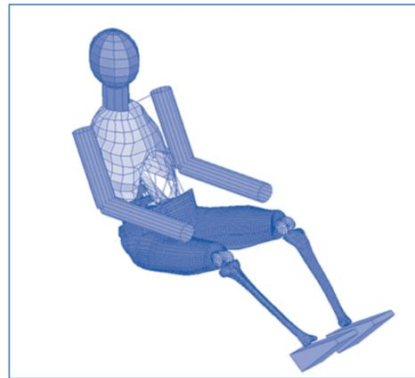
Das numerische Ganzkörpermodell CASIMIR mit nachgiebiger Körperoberfläche im Gesäßbereich
