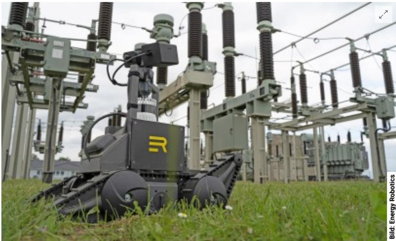
Der Roboter „Rover“ ist für den Außeneinsatz, zum Beispiel für Umspannungswerke, konzipiert.
