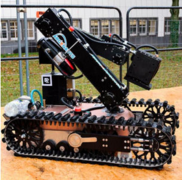
Der Argonaut ist heute der weltweit erste autonome Inspektionsroboter mit offizieller Atex-Zertifizierung. (Bild: Natalie Wocko)
