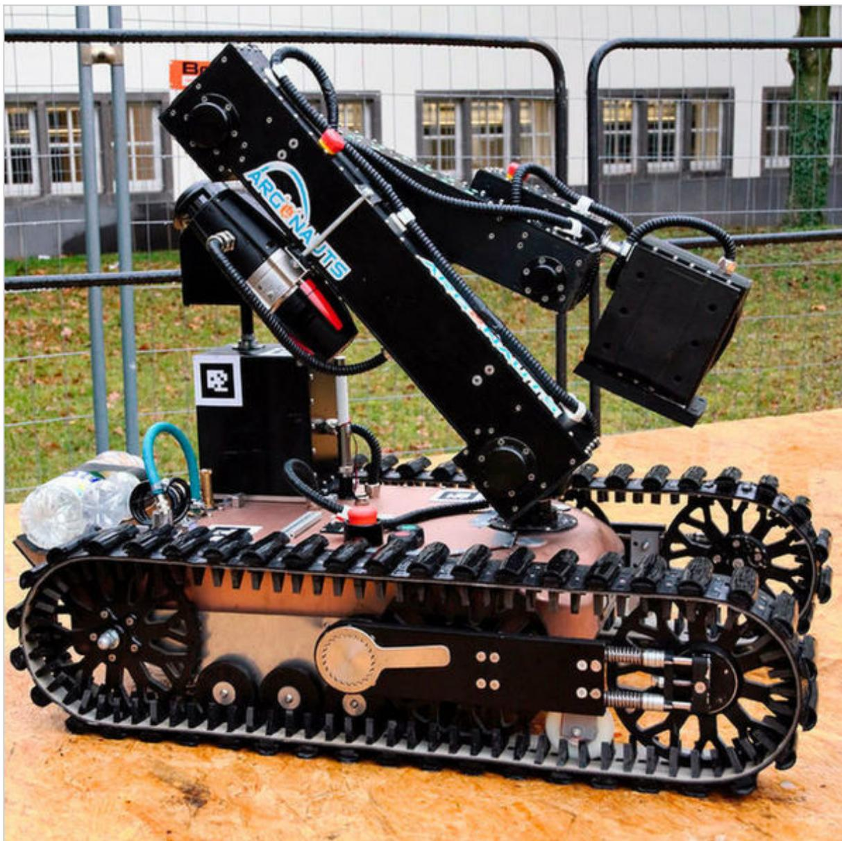
Der Argonaut ist heute der weltweit erste autonome Inspektionsroboter mit offizieller Atex-Zertifizierung.
