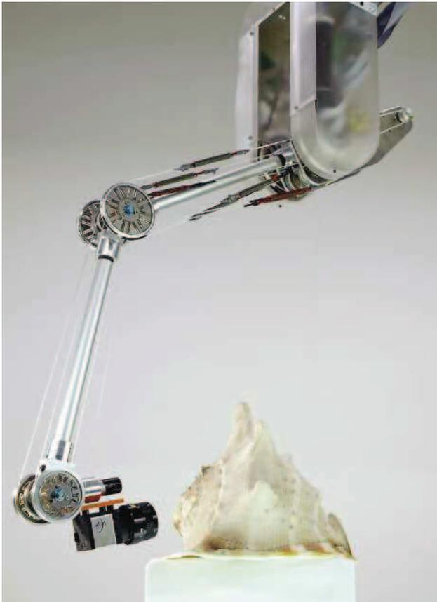
Der BioRob-Arm ist ein neuer Typus von Roboterarmen mit antagonistischem, serienelastischem Antriebskonzept, inspiriert vom elastischen Muskel-Sehnen-Apparat. Dieser markiert einen Paradigmenwechsel in der Robotik von starren zu elastischen Systemen. Er zeichnet sich durch ein hervorragendes Verhältnis von Traglast zu Eigenwicht bei einer am menschlichen Arm orientierten Reichweite, hoher Sicherheit bei Kollisionen und energiesparender Steuerung aus.
