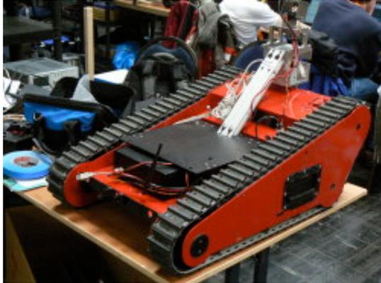
Der Roboter "Matilda" soll beim RoboCup Rescue virtuelle und physische Realität stärker zusammenführen: Software, die sich in der Simulation bewährt hat, wird danach mit dem realen Roboter in der Rescue Arena erprobt.
